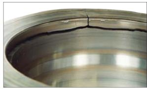
Fig. 32 Crack
